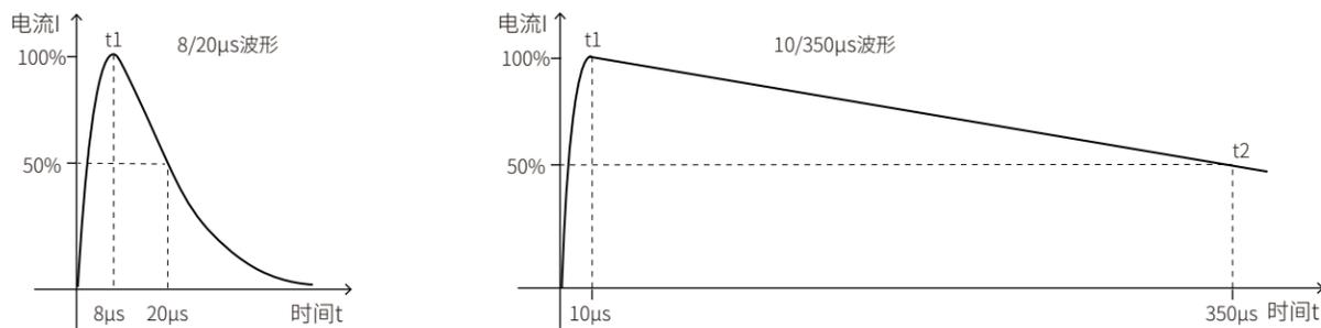
如8/20 $\mu s$ 波形，表示 $t_1=8\mu s$ ， $t_2=20\mu s$ 。 $t_1$ ：波前时间，用来表征雷电“来”的速度， $t_2$ ：半波时间，用来表征雷电“去”的速度。与8/20 $\mu s$ 波形相比，10/350 $\mu s$ 波形半波时间长，在同样的电流峰值下，10/350 $\mu s$ 波形包含的能量 ( $Q=I^2Rt$ ) 远高于8/20 $\mu s$ 波形，选型时注意区分，避免混淆。
