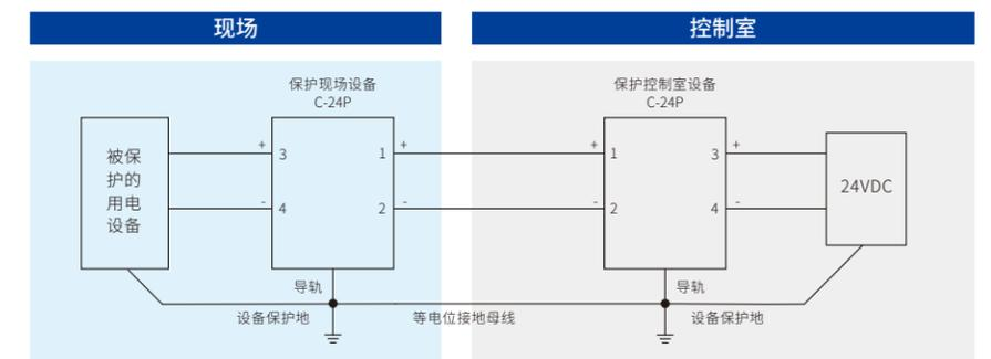
信号SPD用于信号设备的雷电防护，如PLC、DCS、SCADA、变送器、流量计、电磁阀等。适用于AI、AO、DI、DO、RS-485、RS-232、RS-422、热电阻、热电偶等信号。
