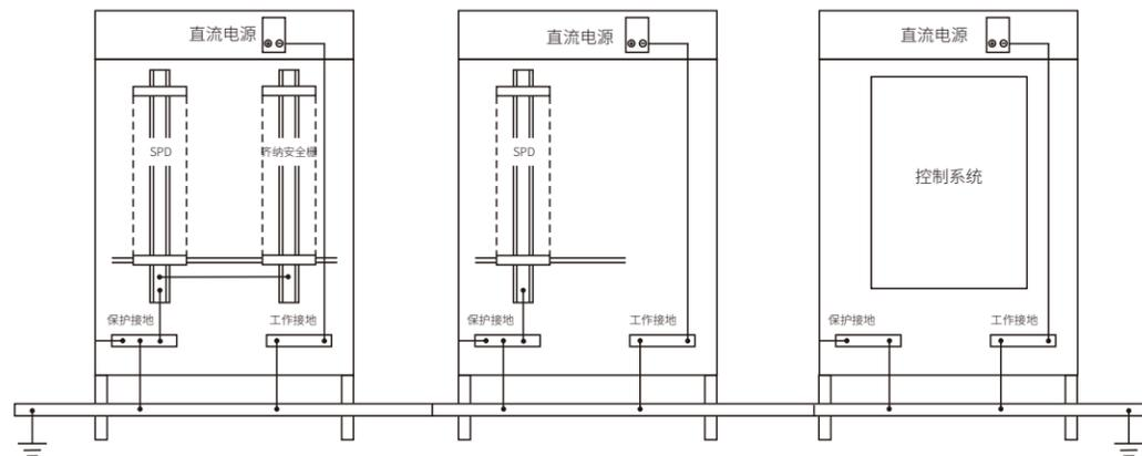
机柜的柜体应连接到机柜内的保护接地汇流条。应为需要接地的仪表、操作设备和金属操作台沿供电电缆路径敷设截面积 $\geq 40\text{mm} \times 4\text{mm}$ （宽 $\times$ 厚）的铜材或热镀锌扁钢作为接地排，操作台接地应就近接到接地排。
