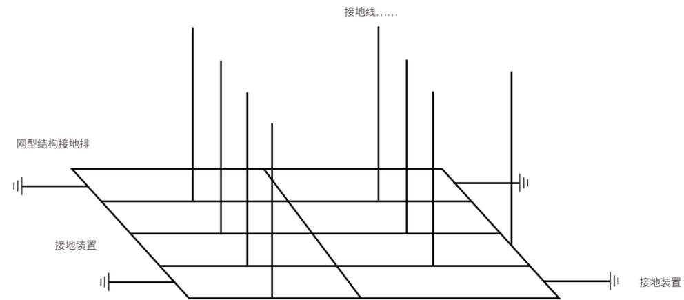
仪表交流电源应采用TN-S系统的接地线，来自供点系统的地线（PE线）应在仪表配电柜内设置接地汇流条；网型结构接地排和配电柜外壳应分别采用截面 $\geq 16\text{mm}^2$ 和 $6\text{mm}^2$ 的多股铜导线的方式连接到配电柜内的接地汇流条上。
