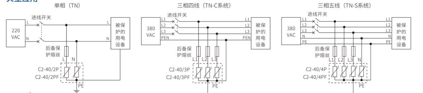
注：应在 SPD 前串接过流保护装置，防止 SPD 老化或短路对供电系统造成危害。
