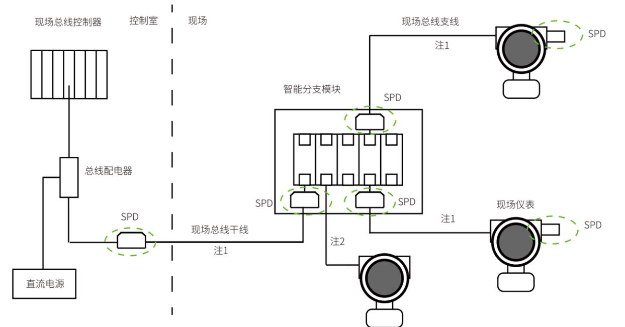
图中：注1为现场总线线路在地面上敷设的水平路径长度大于100m或地面以上垂直高度大于10m，仪表设置SPD；注2为现场总线路不构成此条件，仪表不设置SPD
