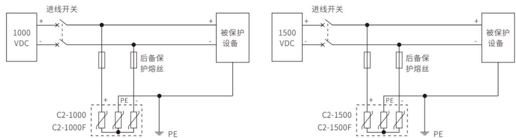
注：应在 SPD 前串接过流保护装置，防止 SPD 老化或短路对供电系统造成危害。
