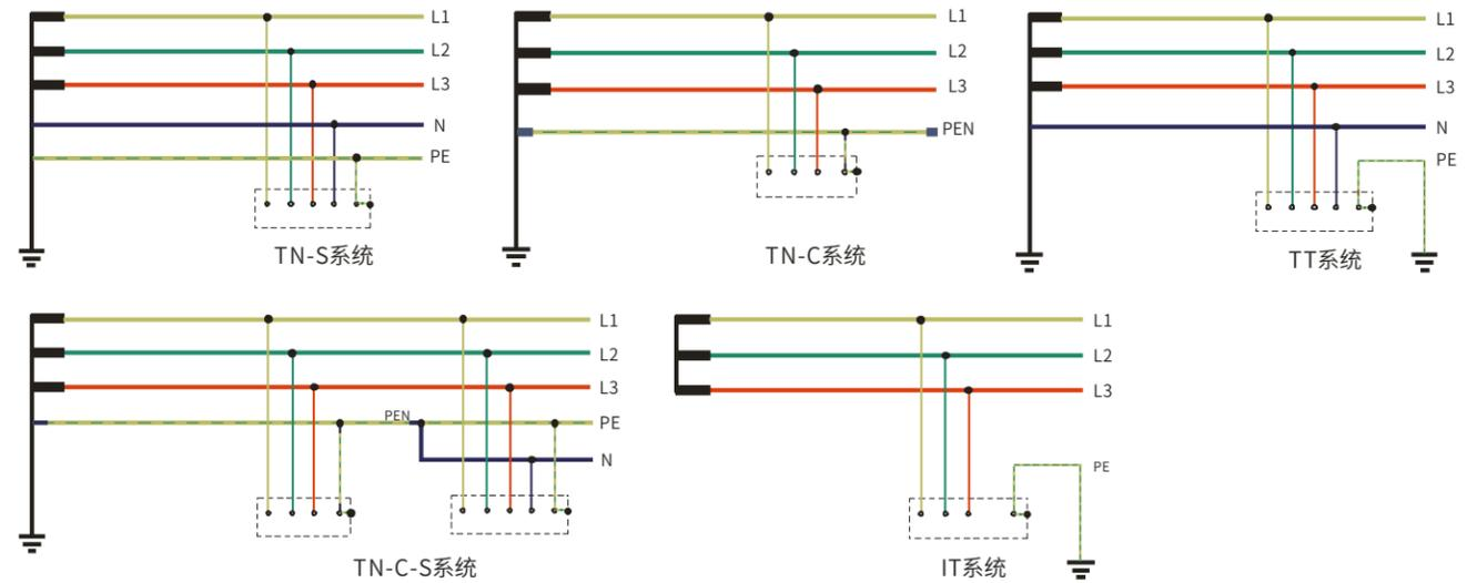
在电源系统中，中性线N会存在电流，如3相电压不平衡时。
