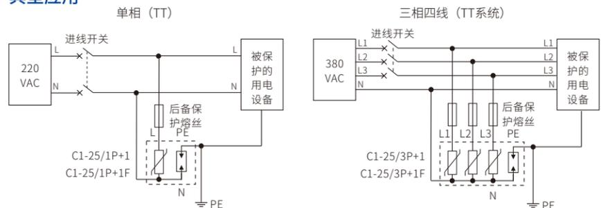
注：应在 SPD 前串接过流保护装置，防止 SPD 老化或短路对供电系统造成危害。
