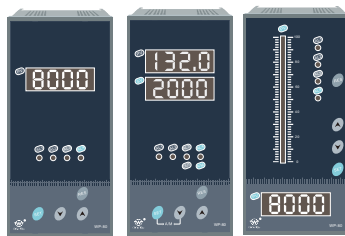
外形尺寸: 80×160×115mm 开孔尺寸: 76_{-0}^{+0.7} \times 152_{-0}^{+0.7} mm
